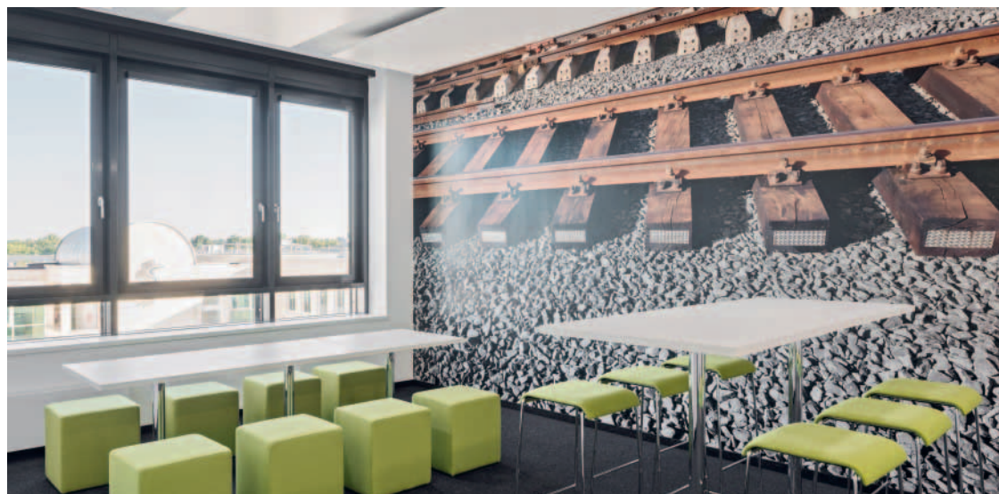
Für das neue Europa-Center der Deutschen Bahn in Berlin hat Erler+Pless insgesamt 400 m 2 Wandfläche mit Tapeten und Textilspannrahmen verziert. Zur Reduzierung des Halls kam zudem Akustikvlies zum Einsatz. Überlebensgroße Makrofotografien von Bahngleisen und Co. stellen die Motive der Raumgestaltung dar.
