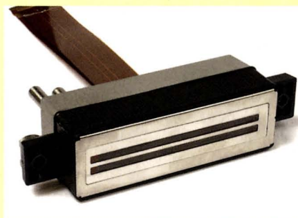
Der Xaar 1001 enthält 1000 aktive Düsen auf einer Breite von 70,5 mm, was 360 dpi ergibt.
