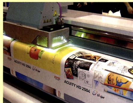
Der Acuity HD 2504 druckt mit Variable-Dot-Technologie in vier brillanten Farben.
